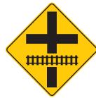
SP-35A INTERSECCIÓN VIAL PRÓXIMA A CRUCE CON VÍA FÉRREA
