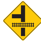
SP-35B INTERSECCIÓN VIAL EN T PRÓXIMA A CRUCE CON VÍA FÉRREA
