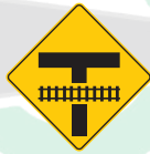
SP-35C INTERSECCIÓN VIAL EN T SECUNDARIA PRÓXIMA A CRUCE CON VÍA FÉRREA
